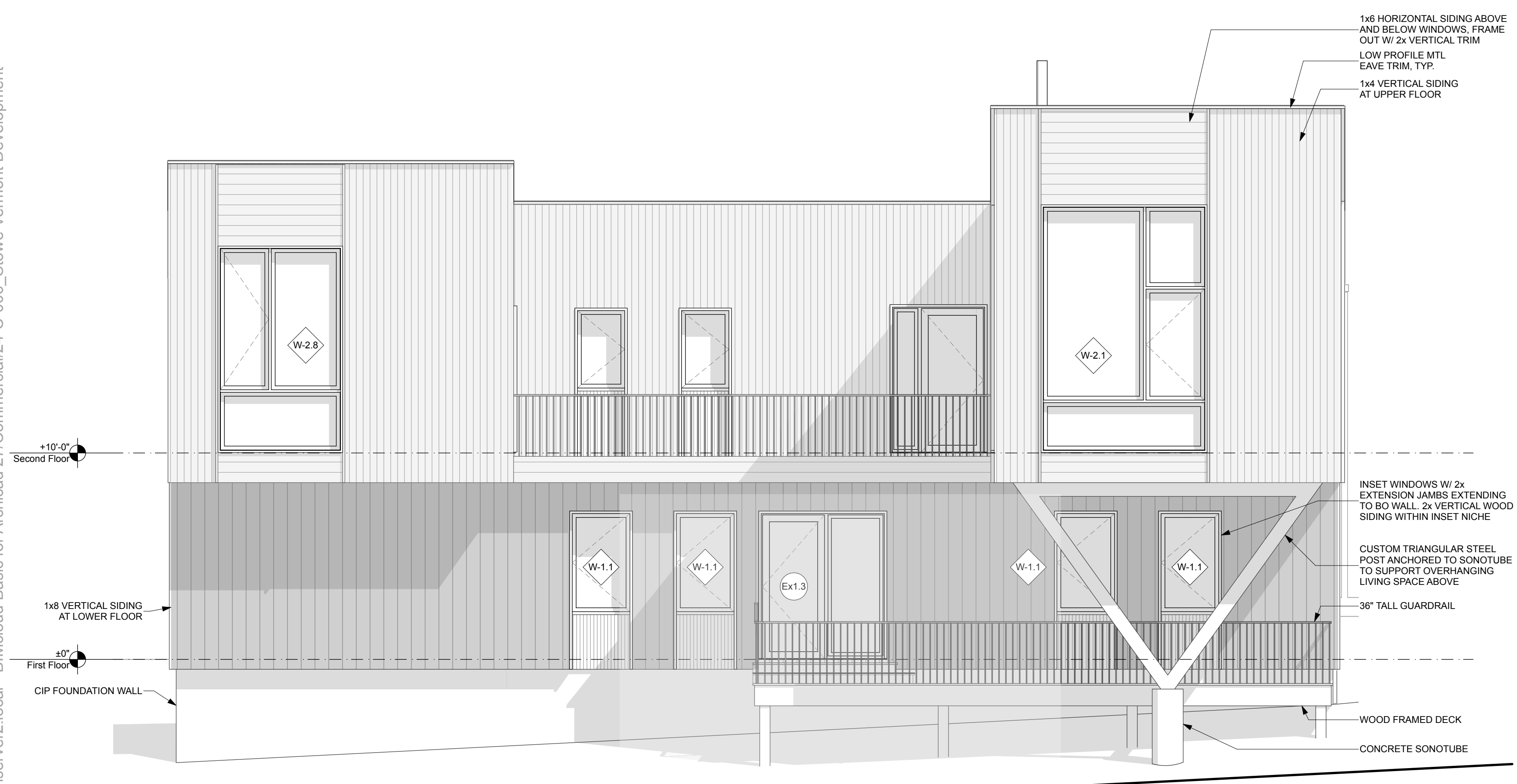
2 BACK ELEVATION SCALE: 1/4" = 1'-0"
